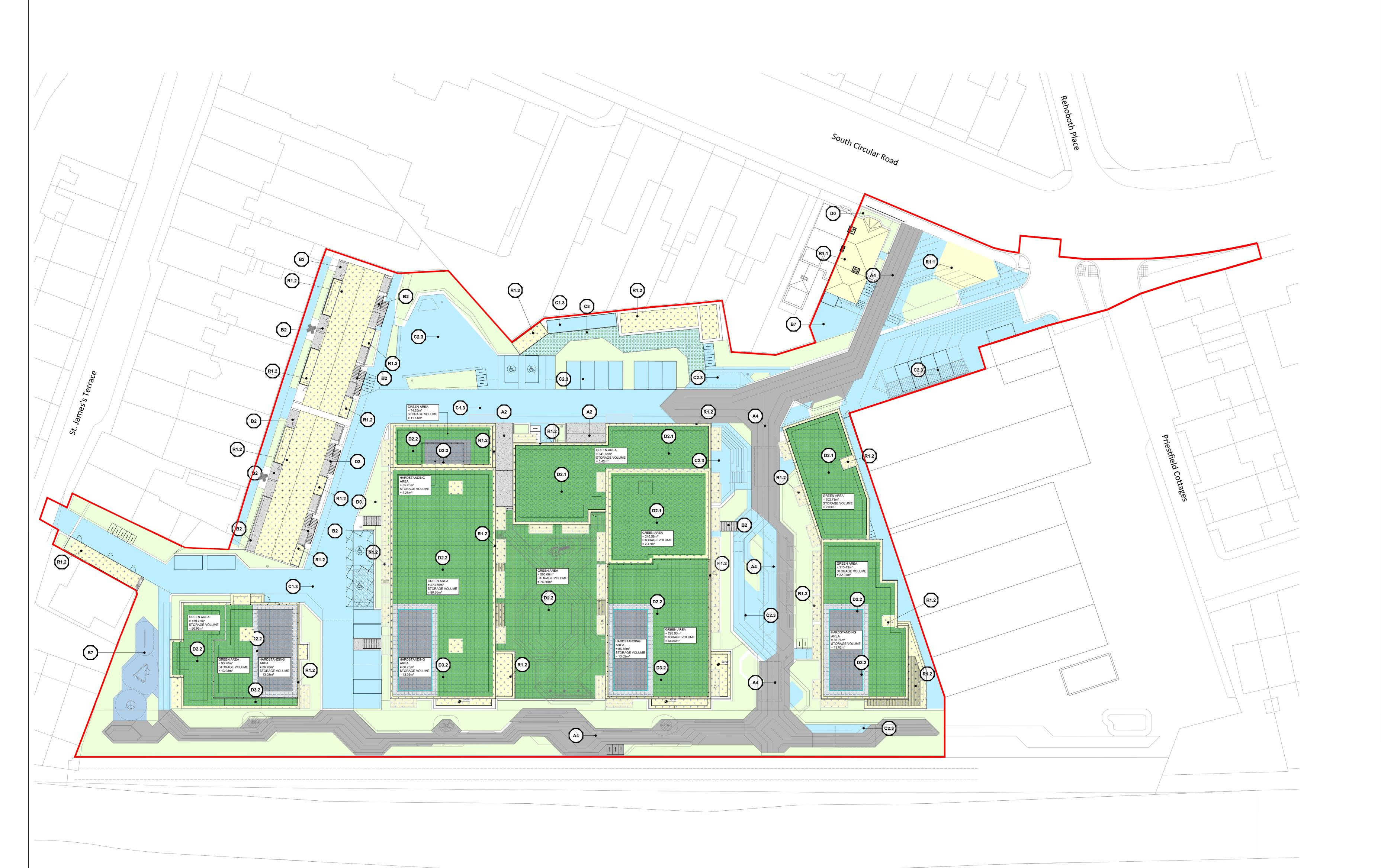
SURFACE LEGEND **SUDS LEGEND** EXISTING ROAD SURFACE CONCRETE **BLOCK PAVED** GRANITE EXISTING FOOTPATHS IMPERMEABLE CONCRETE **BLOCK PAVING** PERMEABLE RESIN BOUND GRAVEL (POROUS) POROUS MACADAM WETPOUR PLAY SURFACE FULL INFILTRATION PERMEABLE PAVED ROADWAY PERMEABLE FOOTPATH
